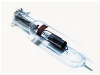
分割陽極マグネトロン (電子レンジ)
