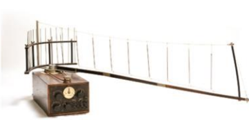
八木・宇田アンテナ (テレビ受信用アンテナ)
