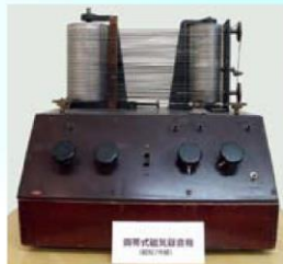
交流バイアス磁気録音方式 (テープレコーダー)
